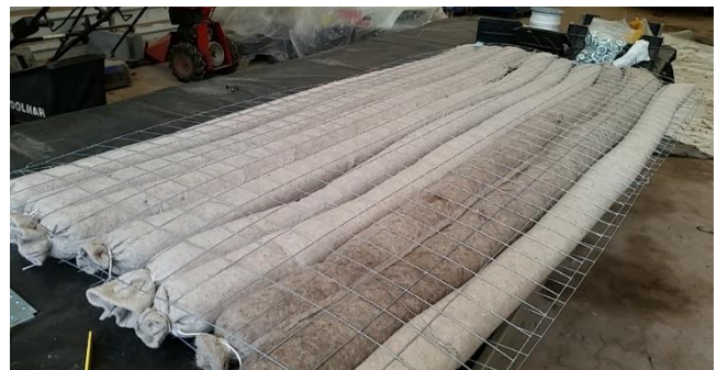
Under produktion: Montering af flydevalser type SW100-K med jord- og bæregitter.
