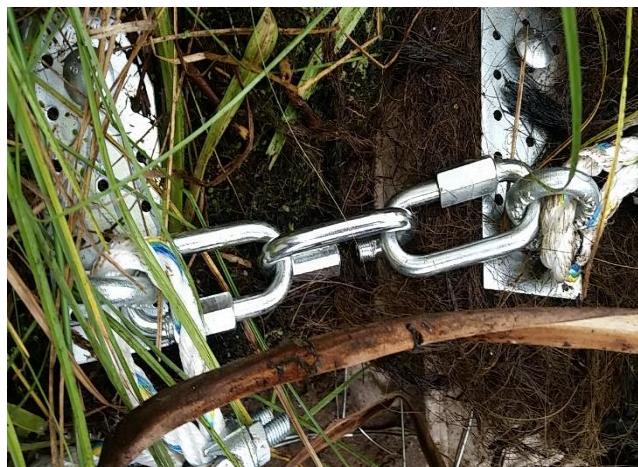
Sammenkobling af enkeltelementer ved hjælp af hurtigkoblinger
