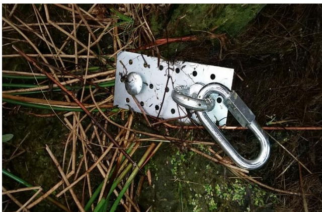
Detailbillede af moderringen til forankring såvel som forbindelsesled til yderligere elementer
